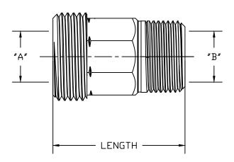
MATERIAL: NO LEAD CAST BRASS ALLOY C89833
